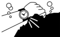
La rotation de la bague de réglage peut être un peu plus difficile sous l'eau. Ce n'est pas un dysfonctionnement.
